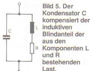
**Bild 5.** Der Kondensator  $C$  kompensiert den induktiven Blindanteil der aus den Komponenten  $L$  und  $R$  bestehenden Last.
